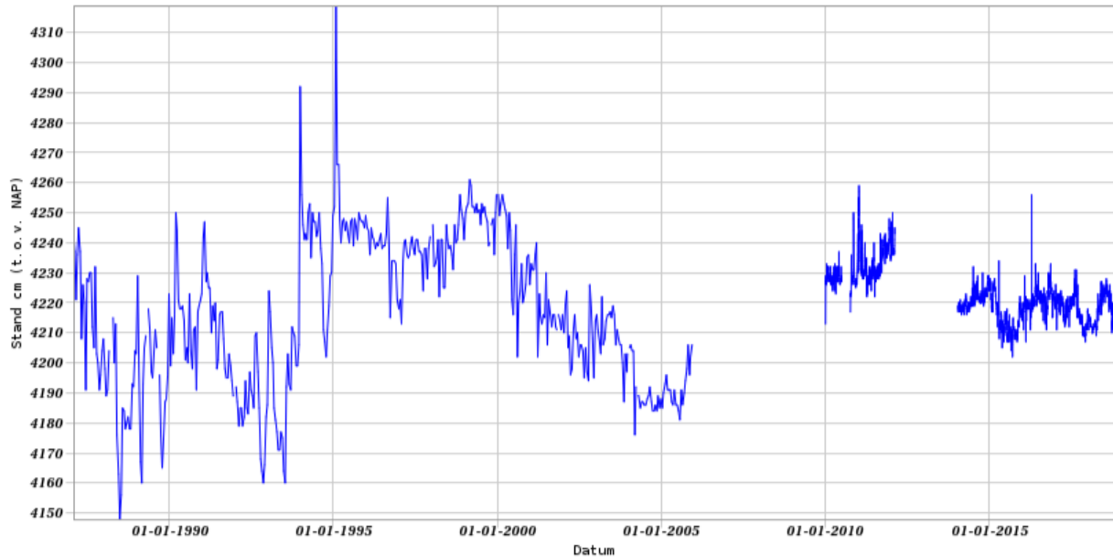
Afbeelding 6 Grondwaterstanden peilbuis B61F0358 in de periode 1990-2015, waarbij in 1995 de hoogwaterpiek van de Maas zichtbaar is in de grondwaterstanden.
